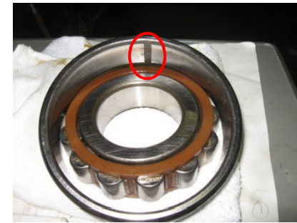
轴承外轮的裂缝
