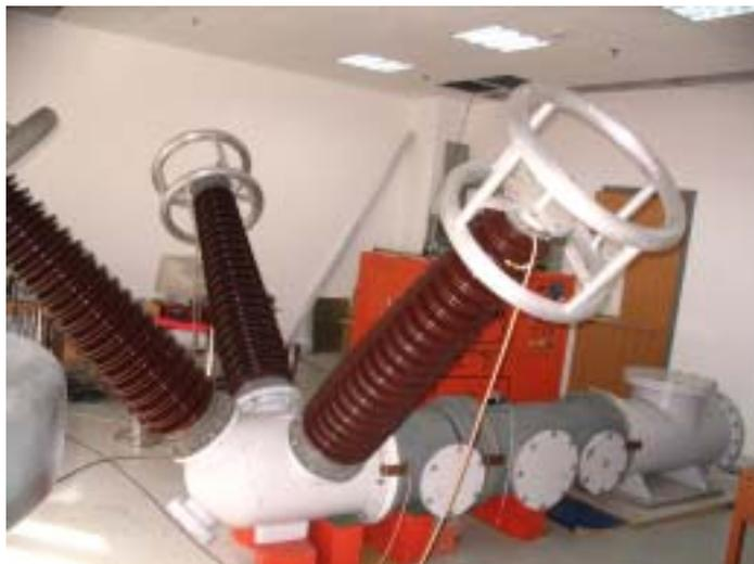
图 5-1 126kV 三相共体 GIS 实体的照片
