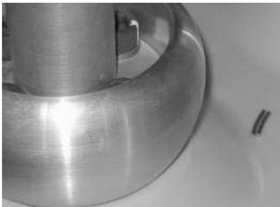
图 5-6 绝缘子上的固定颗粒
